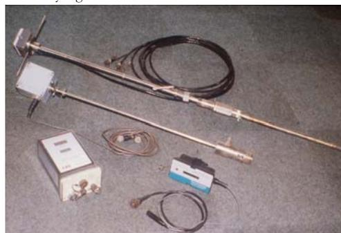
**Figura 19** Sondas de inserción típicas (Fuente: D Pearson (1, 2)).
