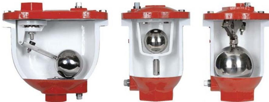
**Figura 15** Válvulas de aire típicas (secciones) (Fuente: Mueller Water Products Inc.)
