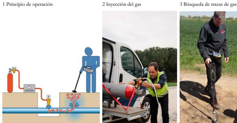
**Figura 36** Técnica de detección de fugas por gas trazador (Fuentes: Primayer (1, 3), EPAL (Lisboa) (2)).
