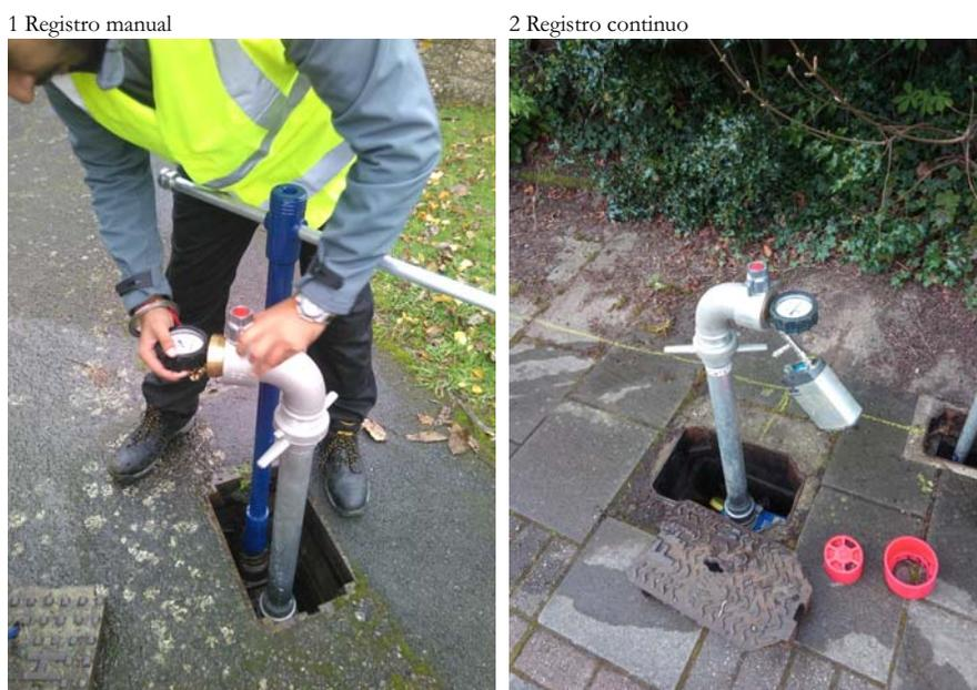
**Figura 33** Uso de hidrantes durante una prueba de presión cero (Fuente: Atkinson (1, 2)).
