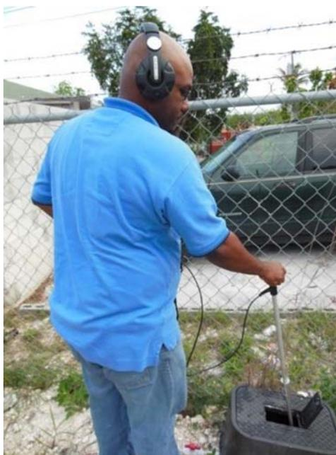
**Figura 31** Uso de una varilla de escucha electrónica (Fuente: Hamilton).
